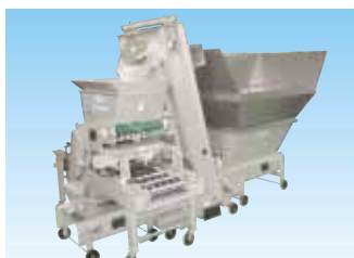
▲ 増量ホッパー+土漏れ防止用 コの字型フェンス (オプション)
