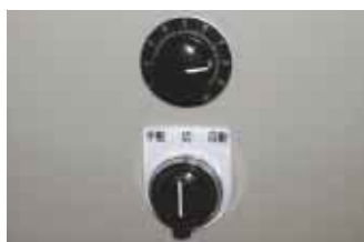
▲ 施肥料調整ダイヤル スピードコントロール付だから 肥料量の調整が簡単。
